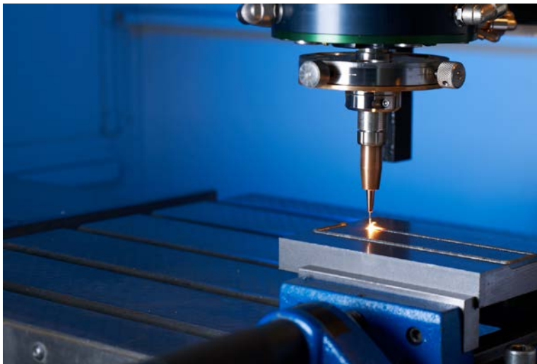
Laserlicht und Draht verschmelzen zu großen und kleinen Bauteilen © Fraunhofer IWS Dresden / Jürgen Jeibmann
